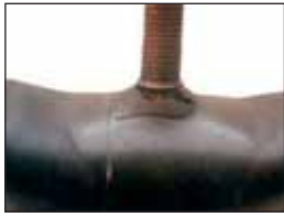
Torn valve stem
